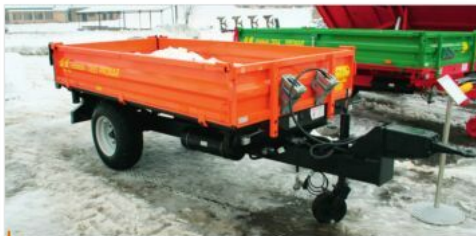
Komunální návěs PRONAR T 655 má nosnost 2000 kg, celkovou hmotnost 2980 kg a ložnou plochu 4,1 m 2
