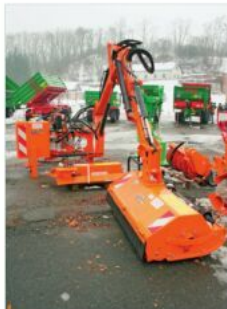
Přikopový mulčovač SaMASZ si poradí s nálety do průměru 3 cm
