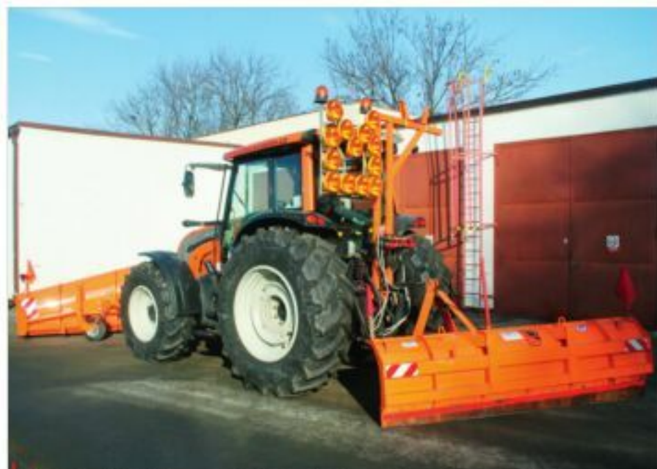
Při zimní údržbě silnic pracuje traktor s čelní a zadní sněhovou radlicí
