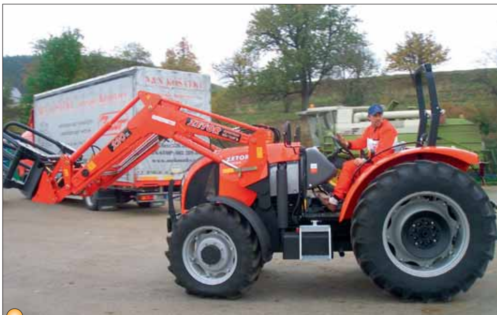
Základními úpravami souvisejícími s provedením bez kabiny je ochranný oblouk, jiné vedení tlumiče výfuku či madla pro snadné nastupování
