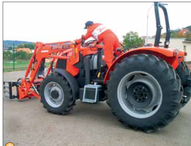
Ukázka odpojení čelního nakladače
