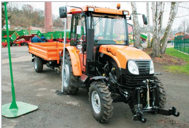
Komunální malotraktor Pronar Zefir 40K poháněný motor Ricardo o výkonu 40 koní. Zadní ramena hydrauliky pracují se zdvihem 760 kg, přední disponují zdvihem 350 kg Foto Roman Paleček
