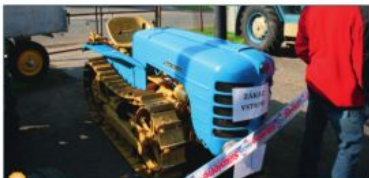
Pásový Zetor 2023. První dvojčíslí udává výkon motoru v koních, třetí číslice znamená pásový traktor, trojka na konci určuje, že jde o traktor úzkorozchodný
