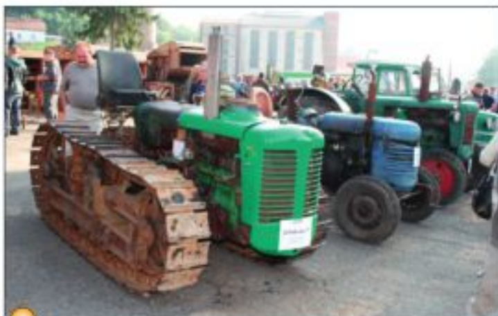
Zetor 35 Super P v pásovém provedení. Vyrábělo se též obdobné provedení se čtyřmi stejně velkými koly (systém County)
