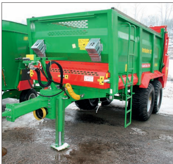
Rozmetadla Herkules mohou být vybavena vertikálním i horizontálním rozmetacím ústrojím a užitečnou hmotností až 14 tun
