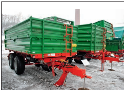
Modely T663 mají užitečnou hmotnost až deset tun a jsou tudíž vhodné pro traktory se jmenovitým výkonem 120 až 130 koní
