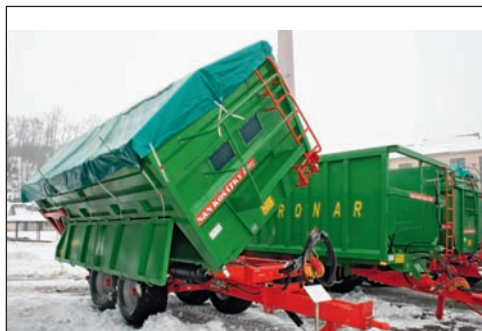
Návěs T669/1 je dvojitě sklápěný a vybavený hydraulicky ovládaným zadním čelem. Celková hmotnost návěsu dosahuje 20 tun, užitečná pak 14 tun
