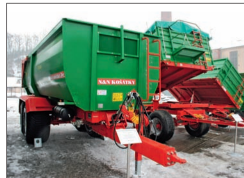
Model T 700 s celkovou hmotností 24 a užitečnou 18 tun je vybaven speciální vanovou korbou
