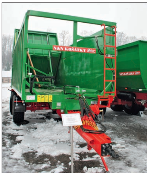
Užitečnou hmotnost 16 tun má model T902. Zajímavostí tohoto vozu je systém vyprazdňování pomocí vytlačného čela
